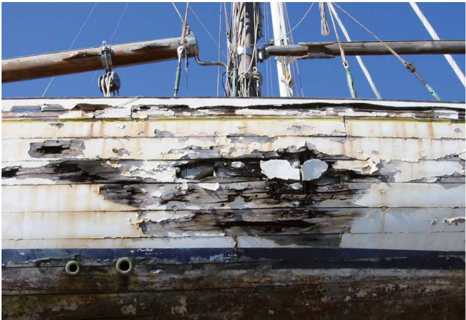
La Spina (12 metri SL, Cantieri Baglietto, 1929) in stato di abbandono, particolare del fasciame. (Vilanova y la Geltrú, Spagna, 2005, fotografia Angelo Esposito, archivio Studio Faggioni)
