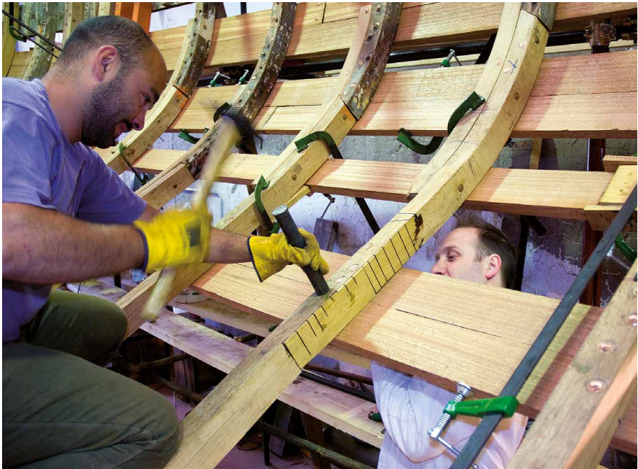
La Spina (12 metri SL, Cantieri Baglietto, 1929). Intervento di restauro: fissaggio dei corsi di fasciame alle ordinate tramite ribattitura dei chiodi in rame. (Castellammare di Stabia, 2005-2006, fotografia Francesco Rastrelli)
