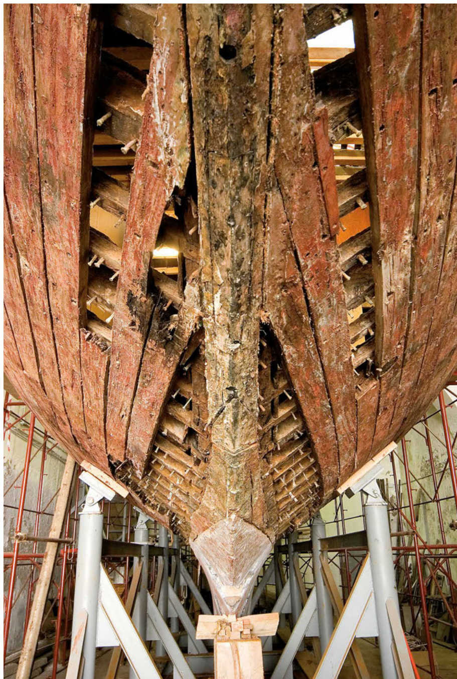
La Spina (12 metri SI, Cantieri Baglietto, 1929). Intervento di restauro: particolare del dritto di prora senza tavole di torello e controtorrello. (Castellammare di Stabia, 2007, fotografie Francesco Rastrelli)
