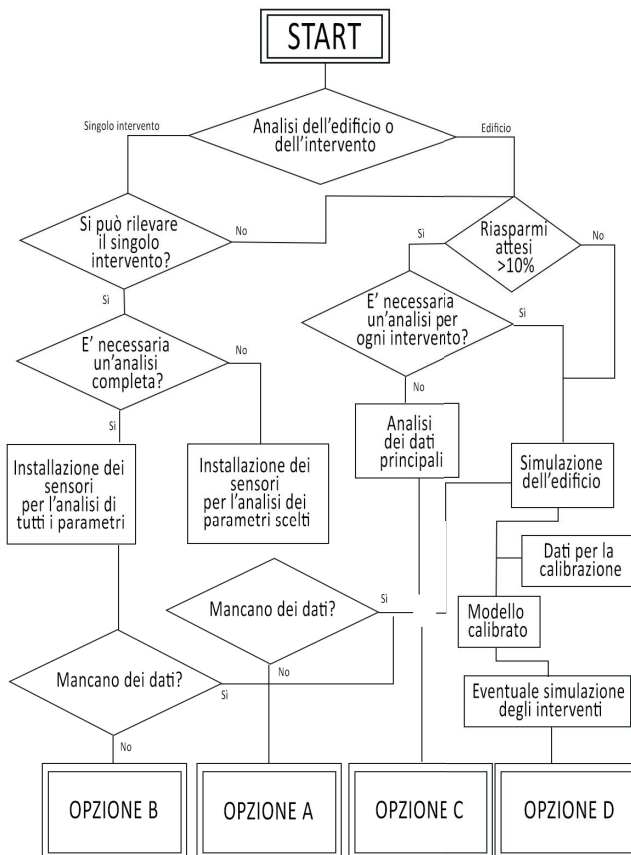
Figura 4.3 - Processo di selezione dell'opzione del protocollo IPMVP.
