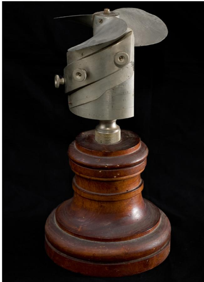
Passometro elica, strumento didattico per misurare il passo delle pale di un'elica. Raccolta strumenti conservati presso il DITEN
