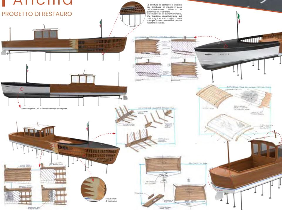
La struttura di sostegno è studiata per distribuire al meglio il peso dell'imbarcazione, evitando le deformazioni localizzate. Si compone di tre componenti metallici, che risulteranno rispettivamente sui due appoggi e sulla chiglia. Questi sono per essere una serie di pezzi in tubolare metallici.
