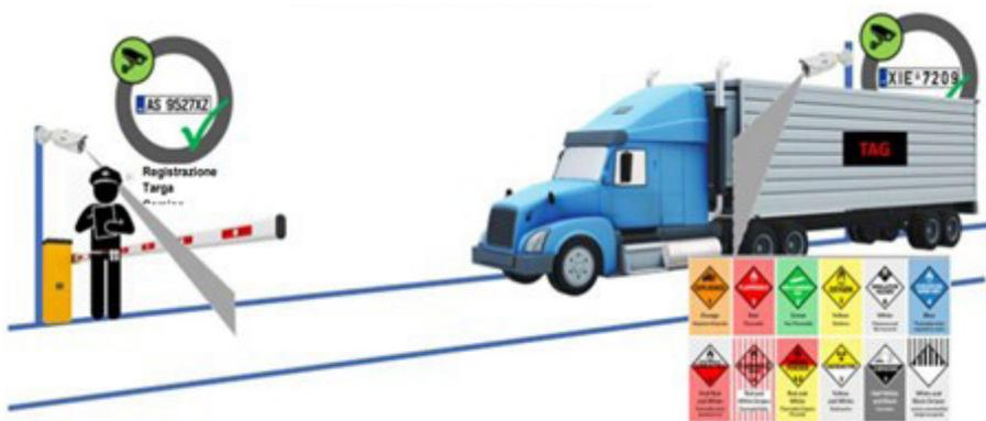
b) Sistemi a scansione Laser e telecamere, che permettono di leggere le targhe ADR applicate sul lato posteriore nel circuito portuale.
