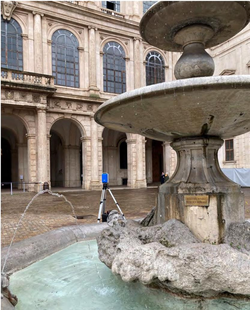
Fig. 1.10. Scanner laser utilizzato per il rilievo scanner di Palazzo Barberini (Fotografia dell'autore)
