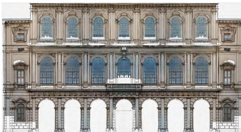
Fig. 1.13. Sovrapposizione della texture ricavata dal rilievo fotogrammetrico e del rilievo originale settecentesco della facciata principale di Palazzo Barberini (Elaborazione eseguita durante l'attività formativa dei dottorati nazionali di Rilievo e Rappresentazione dei Beni Architettonici che si è tenuta presso l'Università di Roma1 – La Sapienza)
