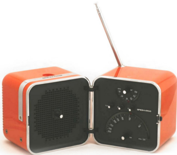
Fig. 7. TS 502, realizzato da Marco Zanuso e Richard Sapper per Brionvega. In produzione dal 1965. Radio portatile dalle dimensioni ridotte, la scocca è realizzata in materiale plastico mentre le due placche interne sono ottenute per pressofusione di zama. Viene comunemente chiamata anche radio 'cubo'.
