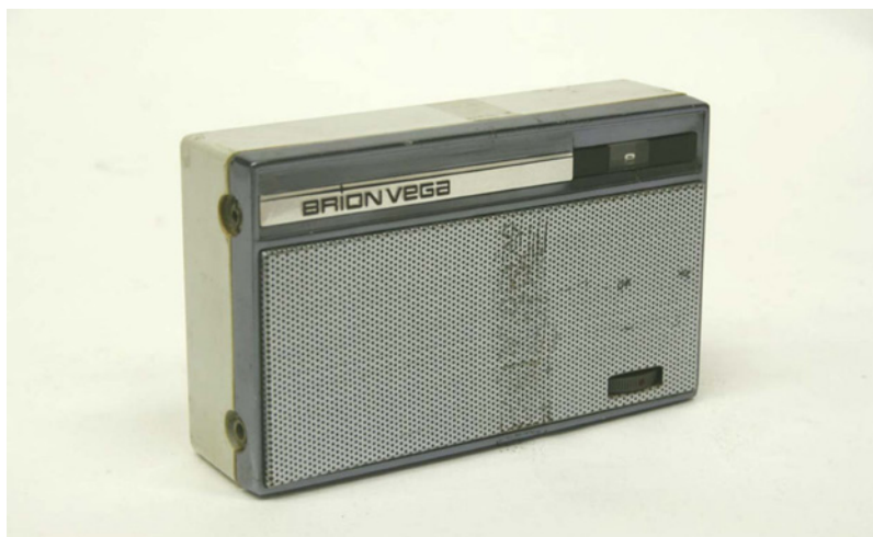
Fig. 1. TS 207, realizzata da Rodolfo Bonetto per Brionvega. In produzione dal 1961. Radio a transistor dalle dimensioni ridotte realizzata interamente in plastica a esclusione della grata frontale. Vendita in abbinamento con custodia a tracolla in pelle.
