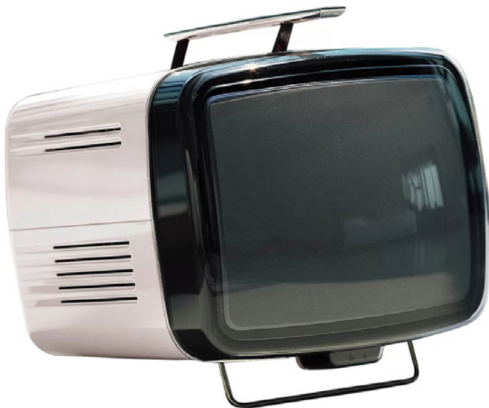
Fig. 5. Doney, realizzato da Marco Zanuso e Richard Sapper per Brionvega. In produzione dal 1962. Televisore trasportabile bianco e nero da 14 pollici, la scocca è realizzata in materiale plastico ABS. Risulta uno dei primi televisori completamente transistorizzati prodotti in Europa.
