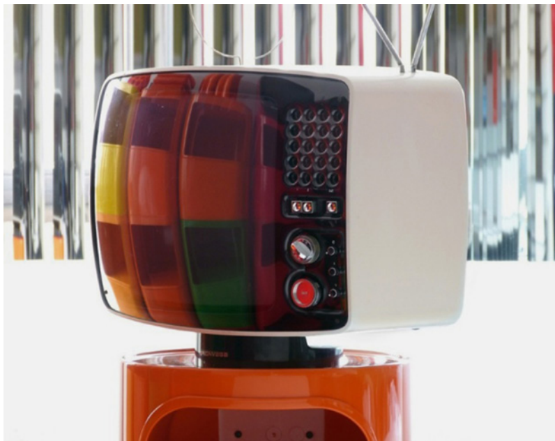
Fig. 11. Volans, realizzato da Mario Bellini per Brionvega. In produzione dal 1969. Televisore bianco e nero da 17 pollici, la scocca è realizzata in plastica ABS bianca nella prima versione, in seguito anche di altre colorazioni.
