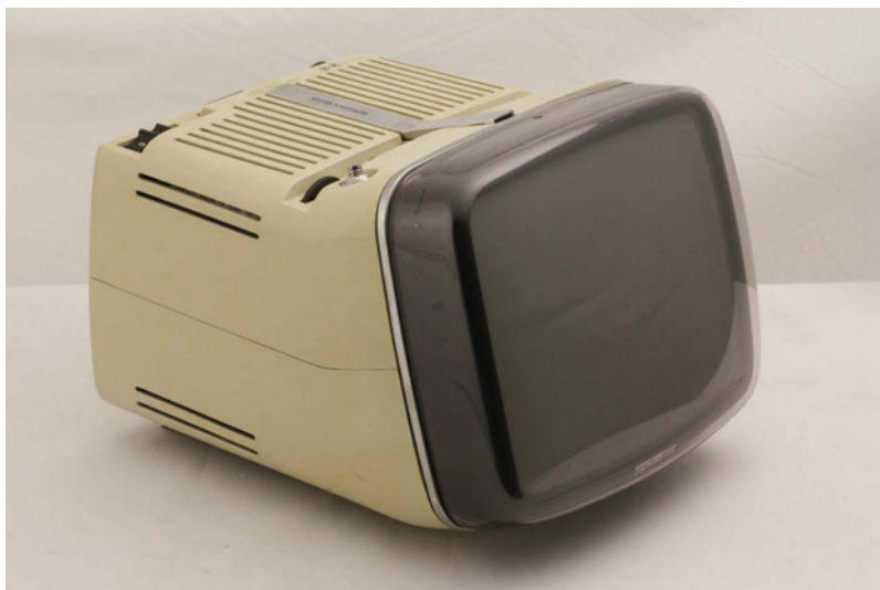
Fig. 6. Algol, realizzato da Marco Zanuso e Richard Sapper per Brionvega. In produzione dal 1964. Televisore bianco e nero da 11 pollici, la scocca è realizzata in materiale plastico ABS in diverse colorazioni.
