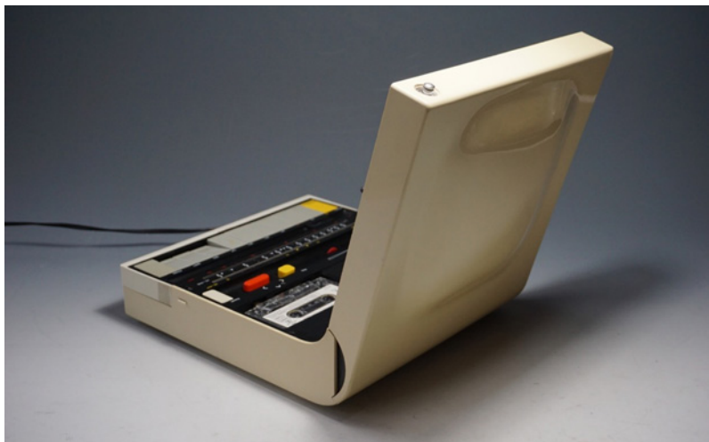
Fig. 9. Soundbook, realizzato dal Marco Zanuso e Richard Sapper per Brionvega. In produzione dal 1972. Strumento per l'ascolto e la registrazione di musicassette, realizzato in materiale plastico ABS.
