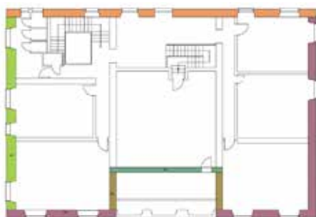
Fig. 23 – Individuazione dei diversi tipi di muratura dell'involucro opaco al Piano Secondo Ammezzato e Sottotetto.
