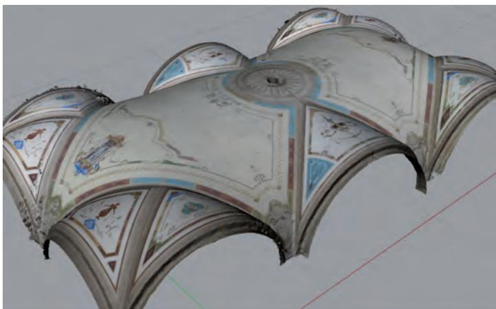
*Fig. 6 - Nuvola di punti texturizzata ottenuta tramite Structure From Motion, Ospedale psichiatrico di Quarto, Genova*
