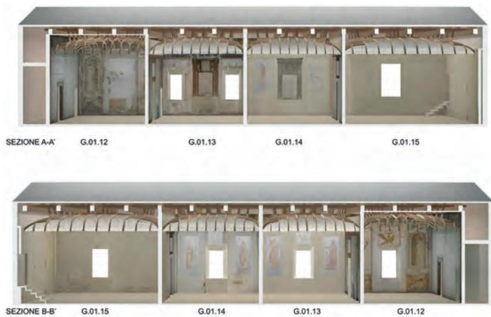
Fig. 142 - Simulazioni dell'intervento di restauro: sezioni longitudinali
