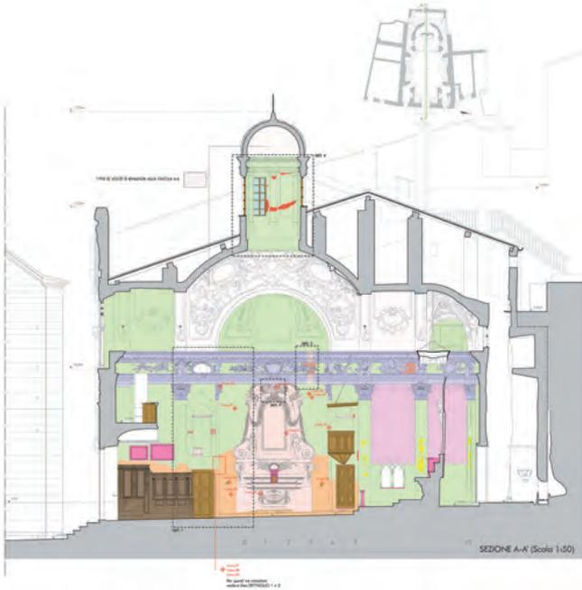
Fig. 83 - Mappa dei materiali: sezione longitudinale a-a'
