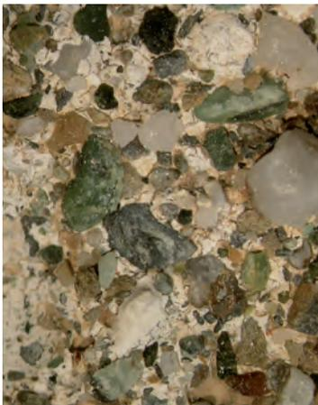
Fig. 12 - Malta prelevata in vico Croce Bianca 10 contenente sabbia di Sampierdarena, utilizzata tra XV e XIX secolo
