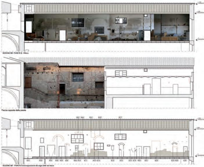
Fig. 118 - Rilievo e interpretazione degli elementi caratteristici e dei segni stratigrafici
