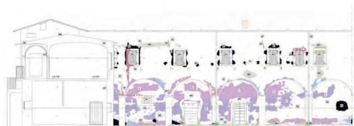
Fig. 253 - Mappa degli interventi di restauro: sezione longitudinale
