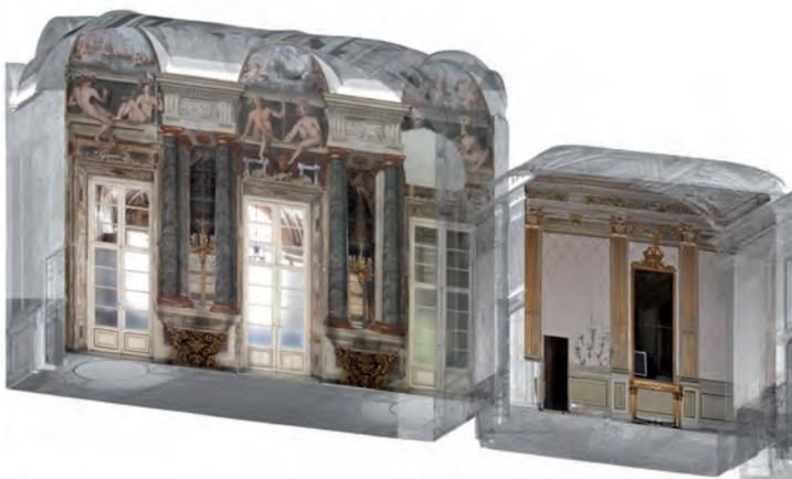
Fig. 35 - Rilievo digitale degli ambienti del piano nobile: elaborazione digitale della nuvola dei punti 3D con inserimento dei fotopiani delle pareti e delle volte
