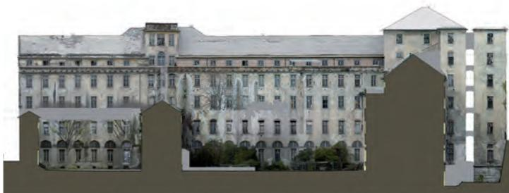
Fig. 40 - Restituzione del rilievo fotogrammetrico: sezione trasversale est-ovest dell'intero complesso dell'Albergo dei Poveri con inserimento dei fotopiani
