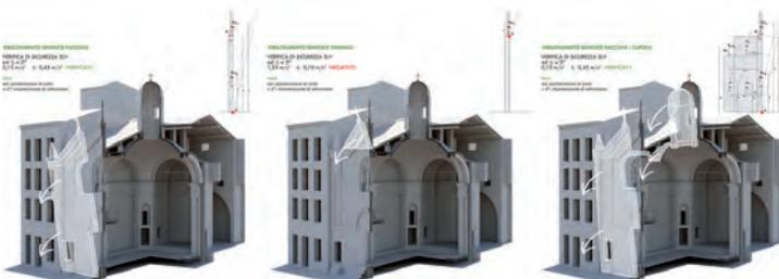
Fig. 84 - Modello tridimensionale: possibili meccanismi locali di collasso
