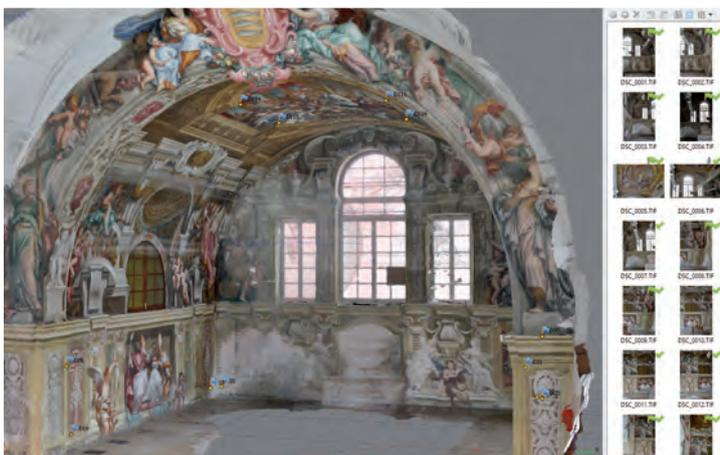
Fig. 25 - Modello tridimensionale della volta a botte della Sala di lettura ottenuto tramite Structure From Motion
