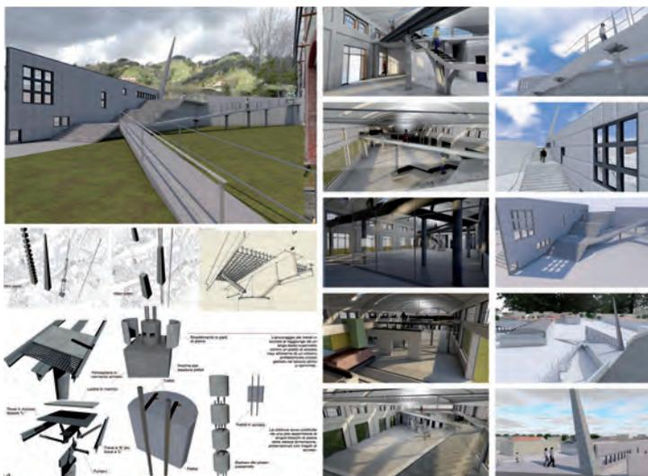
Fig. 91 - Progetto di riuso: particolari della nuova passerella di accesso e render del progetto
