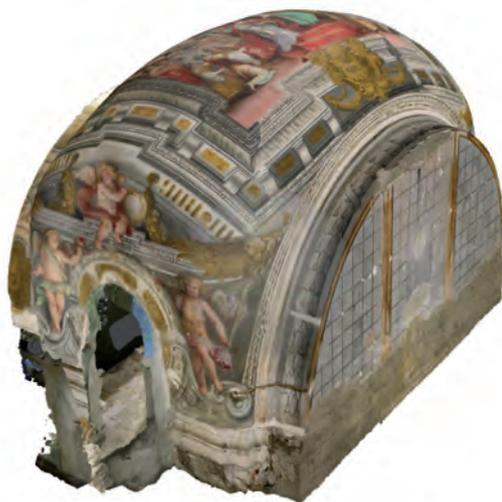
Fig. 26 - Modello tridimensionale di una delle cappelle laterali ottenuto tramite Structure From Motion
