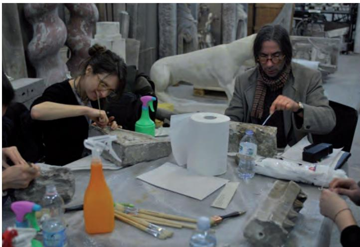
Fig. 62 - Prove di pulitura con bisturi e tamponi di un frammento marmoreo scolpito
