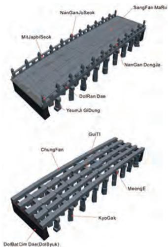
Fig. 179 - Rappresentazione 3D degli elementi strutturali del ponte
