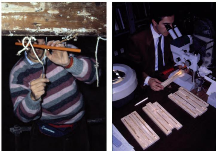
*Fig. 16 - Prelievo di una carota da una trave e studio di carote lignee per l'analisi dendrocronologica*
