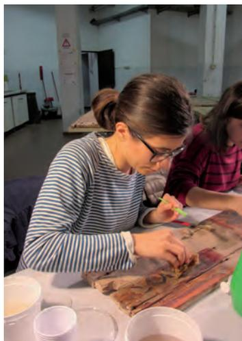
Fig. 53 - Rimozione a spugna dell'eccesso di consolidante
