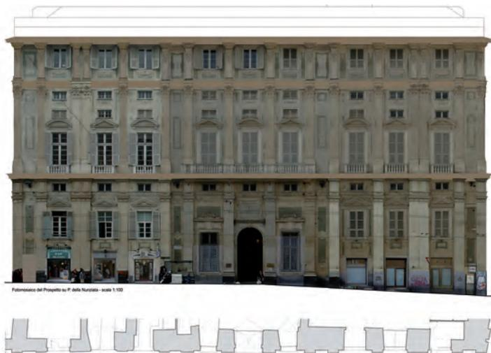
Fig. 34 - Rilievo digitale: fotoraddrizzamento della facciata principale
