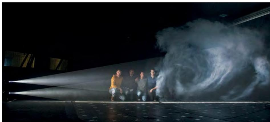
Figura 26.7 Western University, WindEEE Dome, simulazione e visualizzazione di un temporale.
