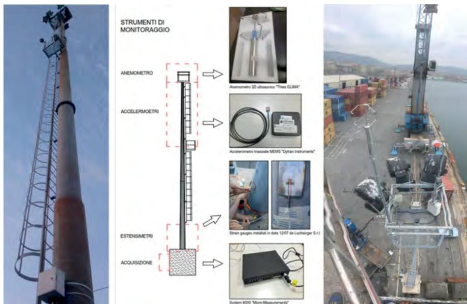
Figura 26.10 Monitoraggio di una torre faro nel Porto di La Spezia.
