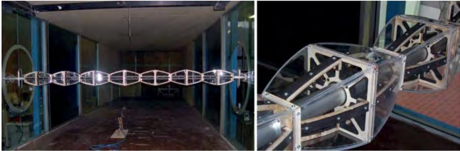
Figura 19.6 La Colonna Senza Fine: prove in galleria del vento su modello aeroelastico.
