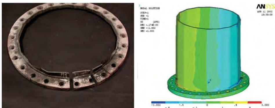
Figura 17.5 Danno reale e simulato causato della fatica indotta dal vento.
