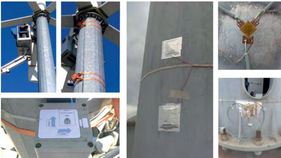
Figura 25.12 Monitoraggio di una turbina eolica ad asse verticale (20 kW) nel Porto di Savona.
