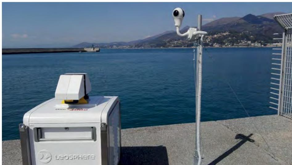
Figura 26.6 LiDAR scanner Windcube 400S nel Porto di Voltri, Genova.
