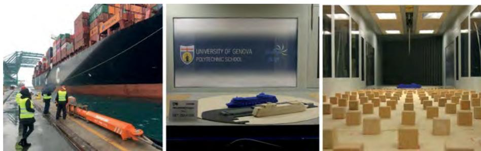
Figure 25.14 Ormeggio delle navi al vero e simulato in galleria del vento.
