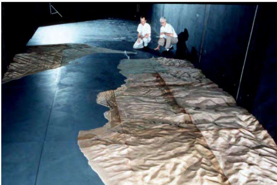
Figura 20.1 Modello topografico dello Stretto di Messina.
