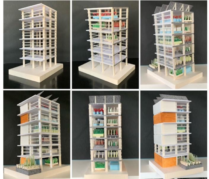
Fig. 4 Foto del plastico di studio, struttura in cemento armato e progressivo utilizzo come serra verticale.
