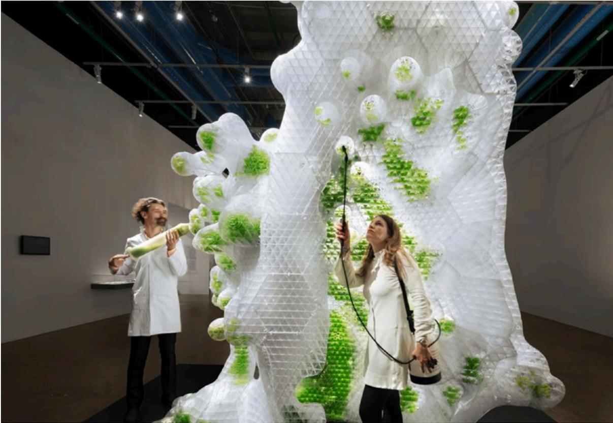
Fig. 28 Ecologic Studio (Poletto-Pasquero). ISTALLAZIONE H.O.R.T.U.S (Centre Pompidou, 2019). Un algoritmo digitale elabora la crescita di un substrato basato sulla morfologia del corallo – mutabile e variabile – integrato in modo pseudo-pensile in una struttura di stampa 3D con strati di 400 micron, supportati da unità triangolari di 46 mm.
