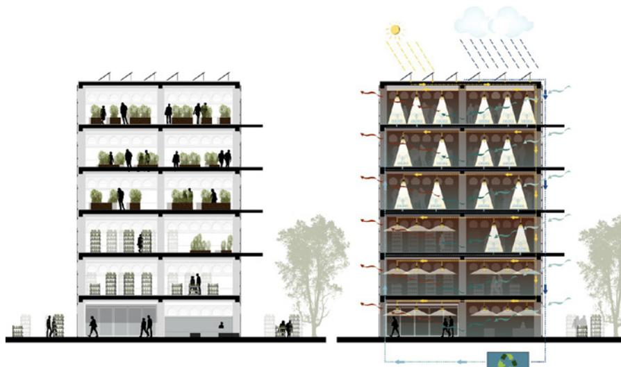
Fig. 5 Sezioni di serre verticali in edifici non finiti organizzate con luce naturale o luce artificiale.
