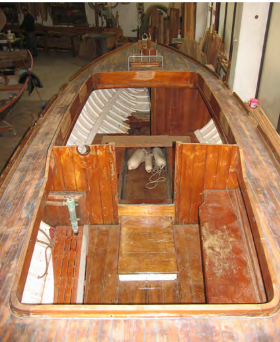
Restauro di Star 1907, foto di cantiere, interventi sulla coperta (crediti fotografici: gentile concessione di Paolo Sivelli).
