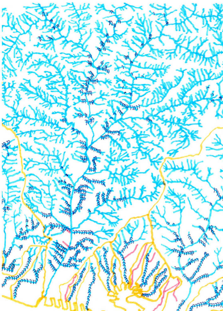
Figura 1: particolare della mappa dei bacini e del reticolo idrografico, dei torrenti e dei rii tombati e delle reti di drenaggio urbano della città di Genova. Rielaborazione dell'autore in tinta fluorescente da: Geoportale della Regione Liguria. Feb. 2021.
